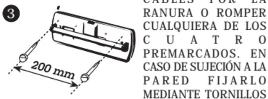
EN LA BASE, PASAR LOS CABLES POR LA RANURA O ROMPER CUALQUIERA DE LOS CUATRO PREMARCADOS. EN CASO DE SUJECCIÓN A LA PARED FIJARLO MEDIANTE TORNILLOS
